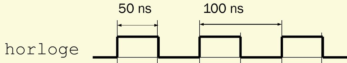
Il s'agit d'une horloge à 10Mhz
