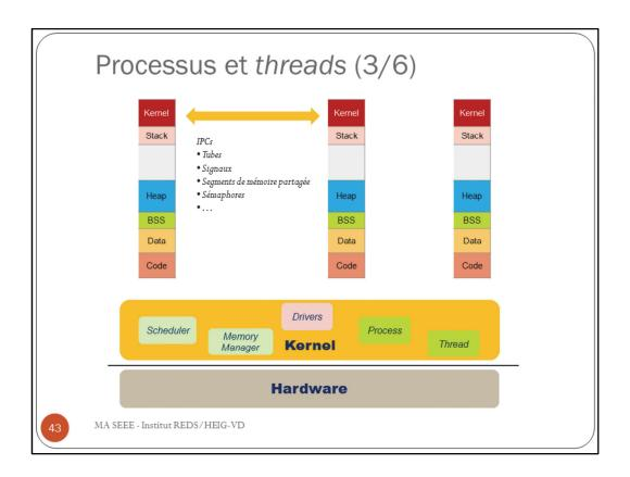
La plupart des noyaux d'OS supporte la notion de processus et de *threads*. Sous *Linux*, la notion de *threads* uniquement est utilisée, un processus étant représenté par le *thread* principal qui contient une référence vers le contexte mémoire. Sous Windows, les deux notions sont bien séparées dans le noyau.
