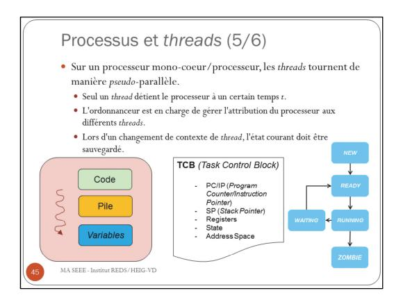
Pour s'exécuter correctement, une fonction doit disposer d'une **pile** d'exécution (arguments, variables locales, imbrication, sauvegarde temporaire, etc.). La fonction peut également avoir recours à des objets globaux (variables globales, objets partagés tels que *mutex* ou sémaphore, etc.).
