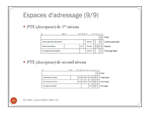
Sur ARM, la PTE de premier et second niveau – appelée *descripteur* dans la terminologie ARM - montre une structure différente en fonction du type de mappage. Lors d'un mappage de section, seul une PTE de premier niveau est nécessaire: les 12 bits de poids fort contiennent la *section base address*. Les bits de poids faible de l'adresse représentent l'offset et sont au nombre de 20 (2<sup>20</sup> = 1 Mo).
