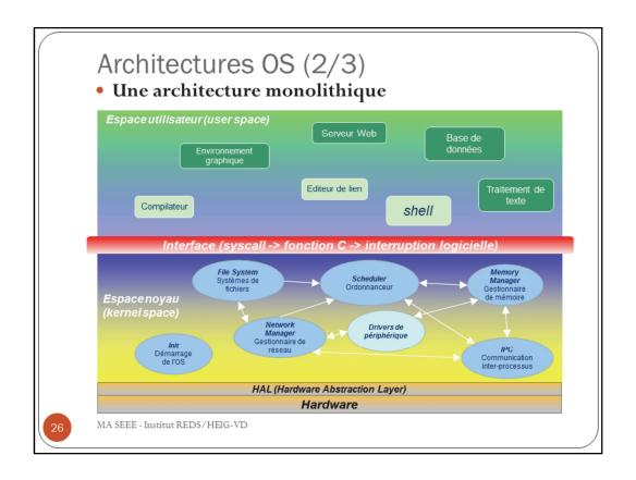
Pour des raisons de performance essentiellement, l'architecture monolithique est la plus utilisée. Elle reste très attractive au niveau de ses performances. Lors du développement noyau, l'accès aux structures noyau est relativement aisé, mais rend le système moins sûr (exploitation de failles de sécurité).
