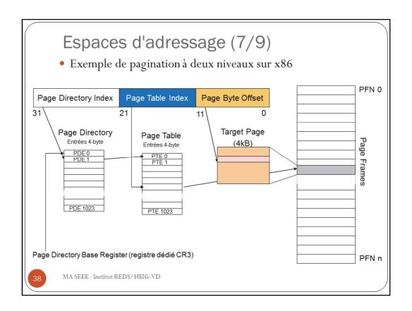
Avec une pagination à deux niveaux, l'adresse virtuelle est décomposée en trois parties: l'index de niveau 1 (ou *Page Directory Index* dans l'exemple), l'index de niveau 2 (ou *Page Table Index* dans l'exemple), ainsi que l'*offset* (ou *Page Byte Offset* dans l'exemple).
