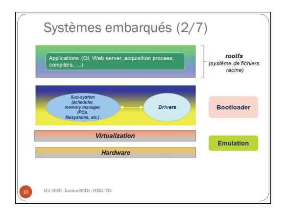
Un système embarqué comporte un ensemble d'applications dédiées composé éventuellement d'un système d'exploitation, voire d'un environnement virtualisé.
