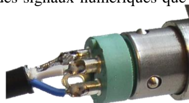
Connecteur symétrique et câble blindé
