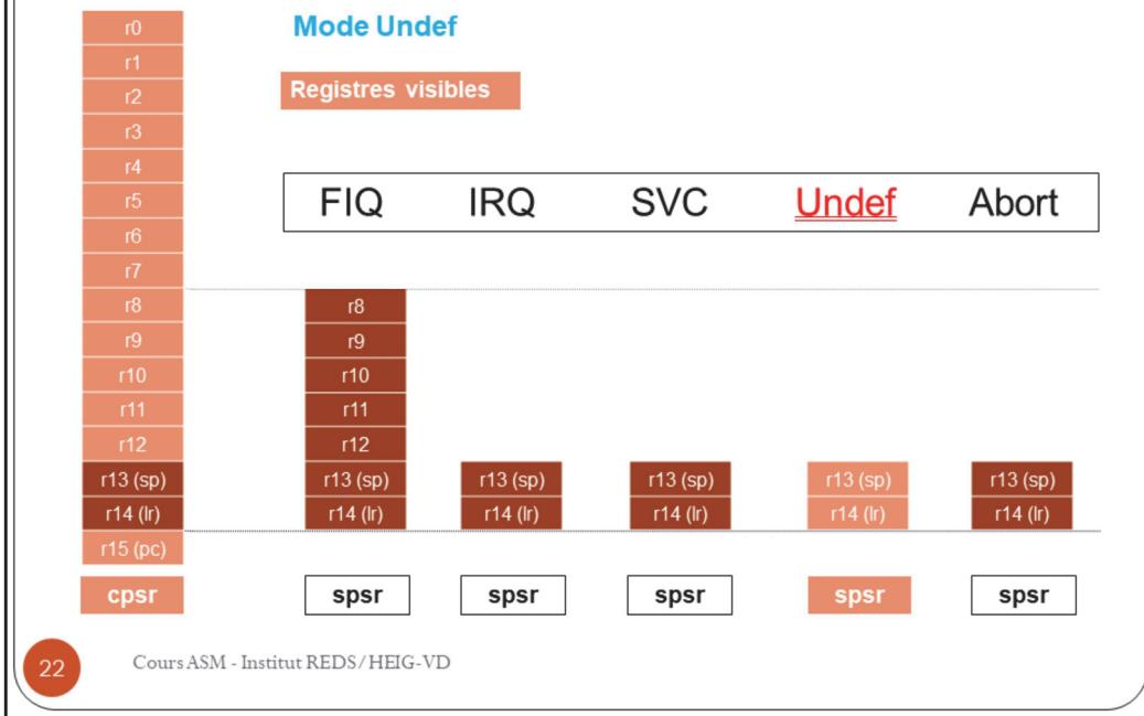
Le mode **Undef** est utilisé lors d'une interruption logicielle correspondant à un échec à l'exécution d'une instruction (instruction non valide).
