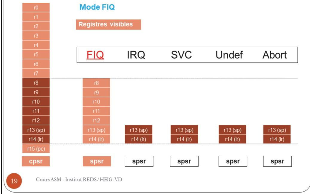
Le mode **FIQ** est utilisé lors d'une interruption matérielle de **haute priorité**. Le cœur ARM dispose en effet de deux lignes d'interruption matérielle, l'une étant réservée pour le type d'interruption FIQ (l'utilisation des deux lignes est sous la gestion du contrôleur d'interruption).
